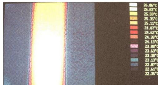
Traction à faible vitesse de déformation sur alliage d'aluminium ( $\dot{\epsilon} = 10^{-3} \text{s}^{-1}$ )
